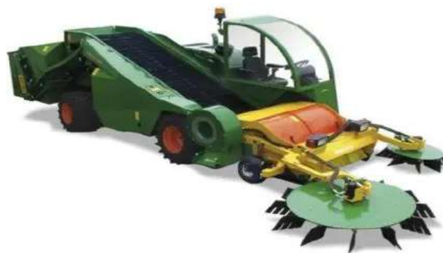
Ilustración 2. 31. Barrederas de frutas y hortalizas.
