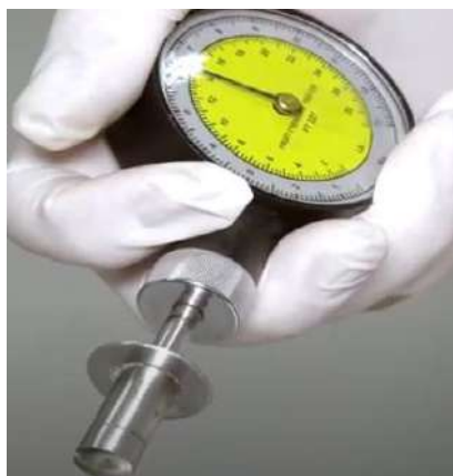
Ilustración 1.19. Penetrómetro, instrumento de medición de dureza.
