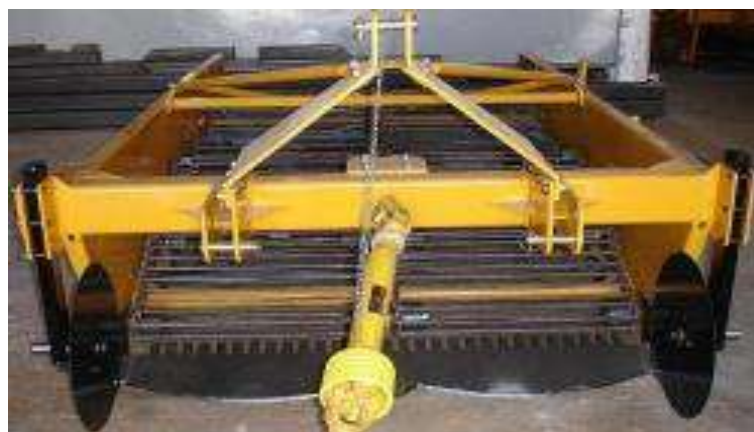
Ilustración 2. 34. Máquina cosechadora de papa.
