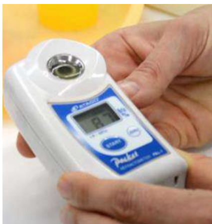
Ilustración 1.18. Determinación de SST en zumo de naranja mediante refractómetro.
