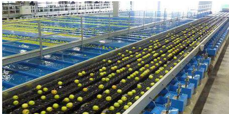
Ilustración 2. 22. Lavado y desinfección de frutas en empacadoras.
