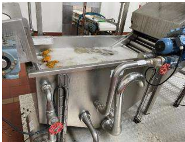
Ilustración 2. 44. Lavado y desinfectado de piña.
