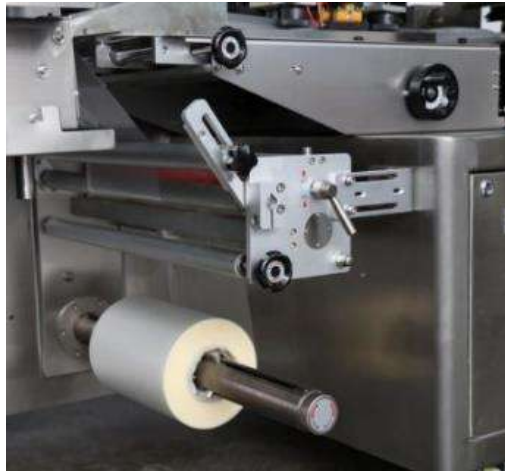
Ilustración 2. 58. Máquina empaadora de frutas y hortalizas.
